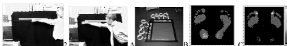
Fig. 1 – 1-2 FR test; Sensore per mappe di pressione (A) e mappe plantari a inizio prova (B) e in massima estensione(C).
